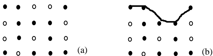
Figura 9.17. Protecția anticorozivă prin modificarea compoziției materialului metalic
